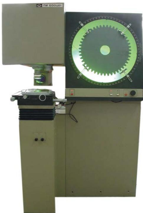
Рисунок 1 – Проектор измерительный ПИ 600ЦВ1
