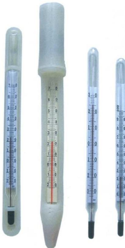
Рис.1 Термометры стеклянные ТС-7-М1
