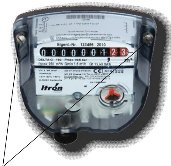
Рисунок 2- Места пломбирования счетчиков газа ротационных Delta Знак поверки наносится на винты крепления крышки отсчетного устройства счетчика.
