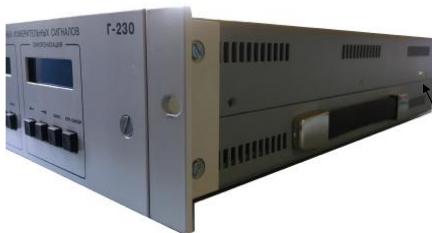
Рисунок 3 – Схема пломбировки генератора от несанкционированного доступа
