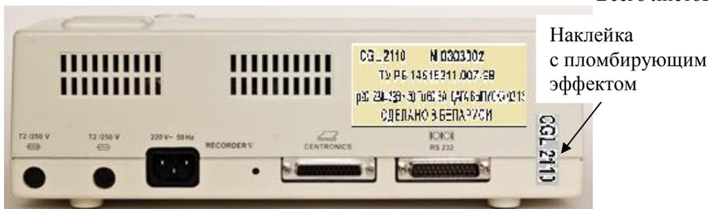
Рисунок 2 – Общая схема маркировки и пломбировки гемокоагулометров
