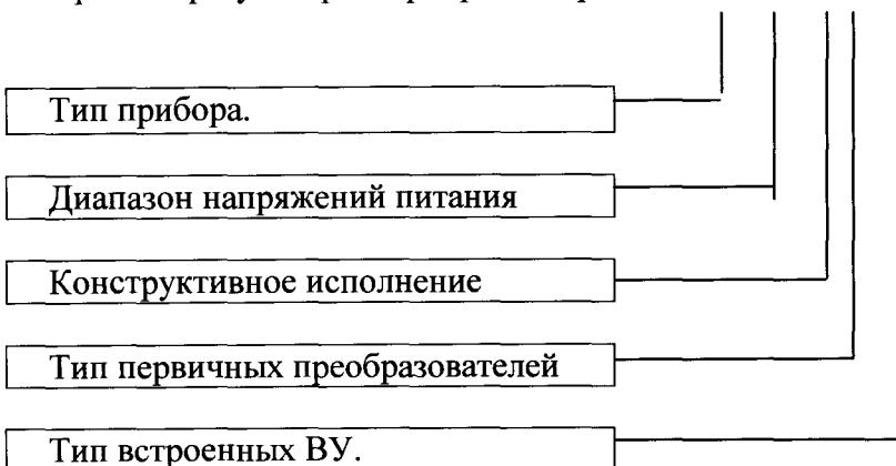
Примечание - Для приборов 2TPM0 в коде полного условного обозначения символ «Тип встроенных ВУ» отсутствует.
