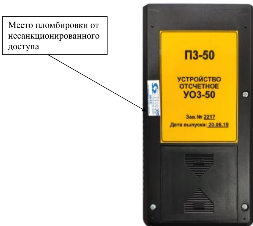
Рисунок 3 – Общий вид задней панели устройства отсчетного УОЗ-50
