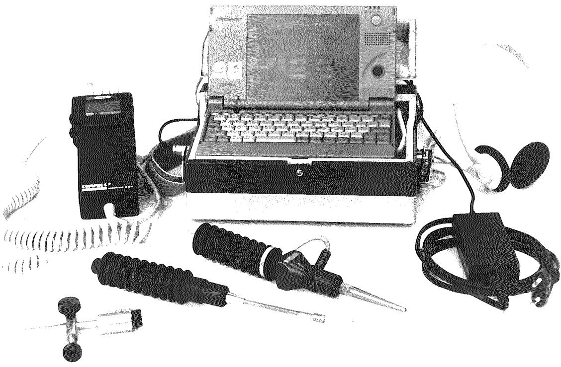
Рисунок 1 - Внешний вид переносной вибродиагностической системы
