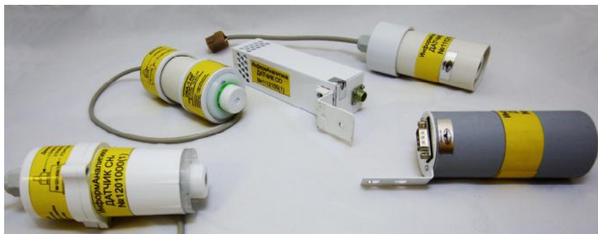
Рисунок 2 – Общий вид блоков датчиков стационарных газоанализаторов
