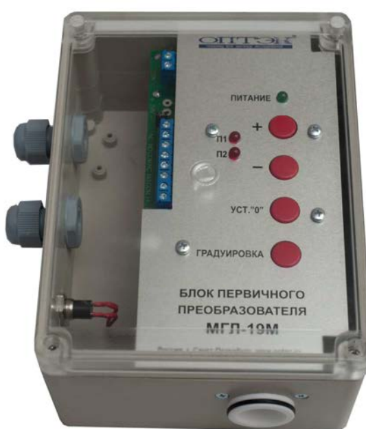
Рисунок 1 – Внешний вид моноблочного газоанализатора
