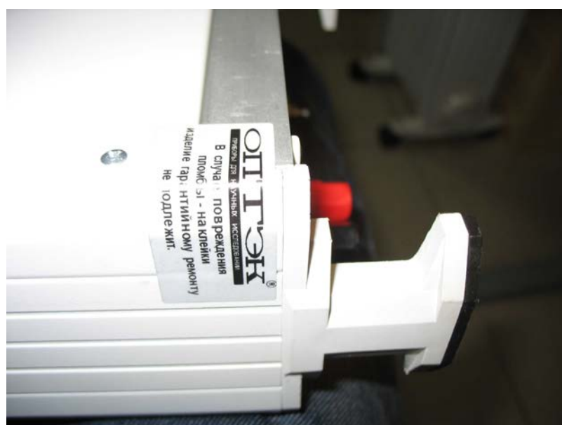
Рисунок 3 – Схема пломбировки БОИ
