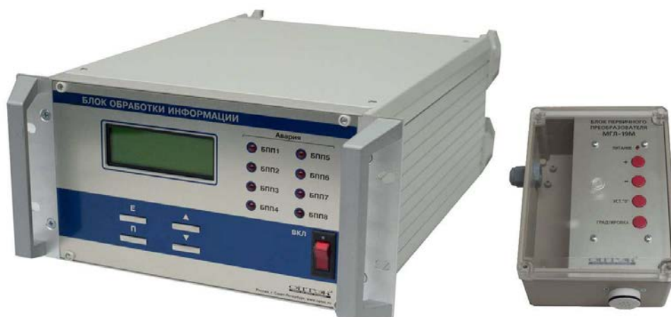
Рисунок 2 – Внешний вид многоблочного газоанализатора
