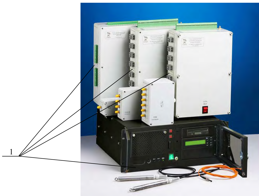
1 – Место для нанесения отпечатка клейм
