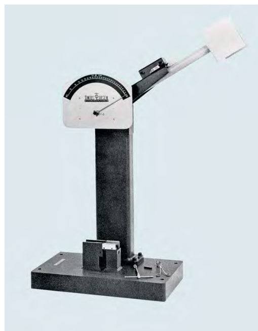
Рисунок 2 – Общий вид копра IT 406
