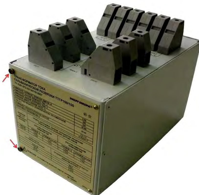
Рис. 1 – Общий вид ТТГР исполнения ТТГР100/100 и места клеймения после поверки
