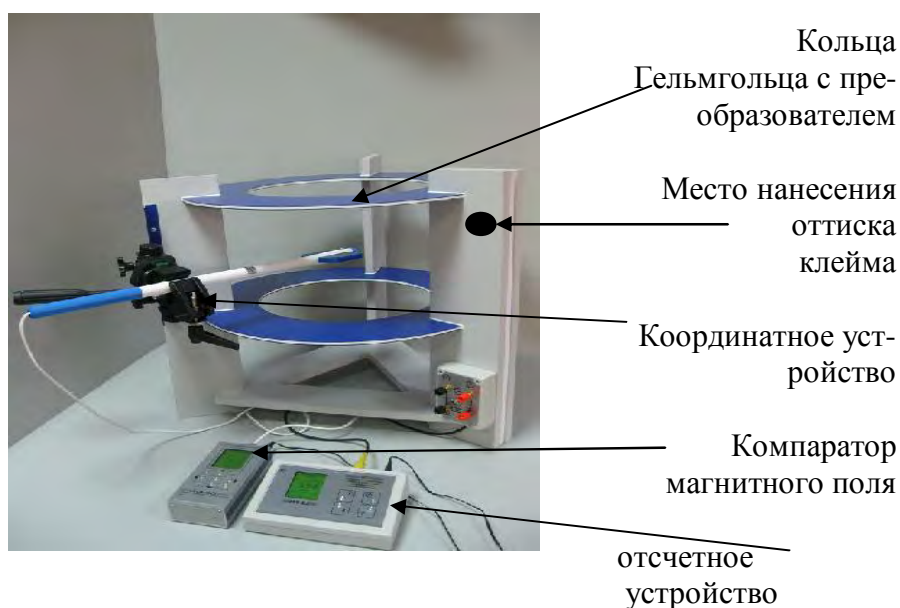
Рисунок 1 – Общий вид установки поверочной средств измерений напряженности магнитного поля П1-22
