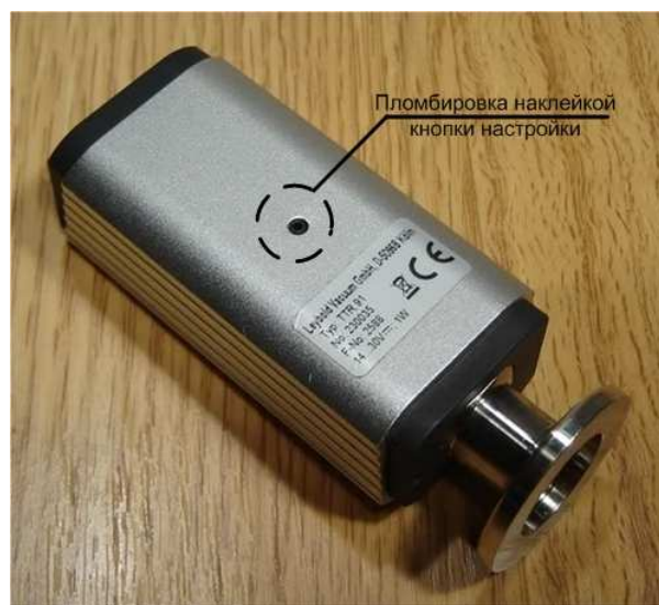
Фото 2 - Схема пломбировки датчика THERMOVAC TTR 91 230 035
