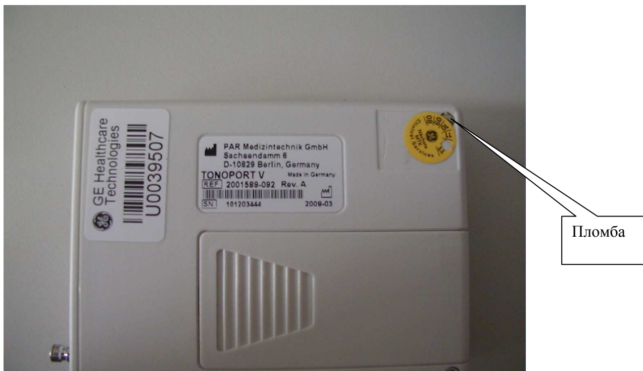
Рисунок 2 – Монитор 24 часовой регистрации АД пациента носимые Tonoport V, расположение наклейки, закрывающей доступ к органам настройки
