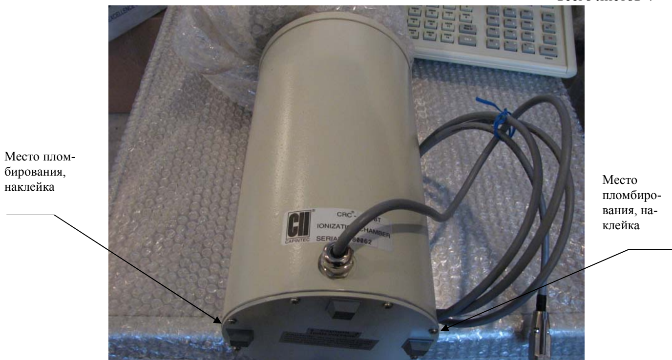
Рисунок 2 — Места пломбирования ионизационной камеры от несанкционированного доступа
