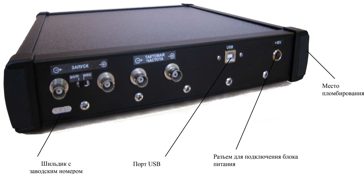
Рисунок - 2 Схема пломбирования и маркировки задней панели генератора
