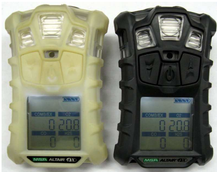
Рисунок 1 - Газоанализаторы портативные ALTAIR 4X (слева версия с фосфоресцирующим корпусом, справа - обычным)
