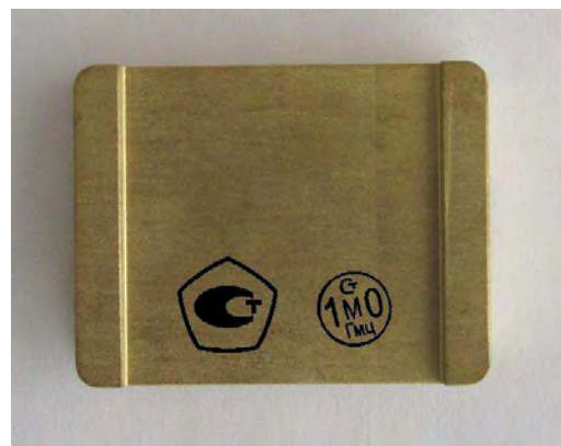
Меры профильные ПРО-10 в комплекте из 3-х, 6-ти и 10-ти мер (вверху) и отдельные меры (внизу) - виды сбоку, сверху и снизу с указанием мест нанесения знака утверждения типа и поверительного клейма
