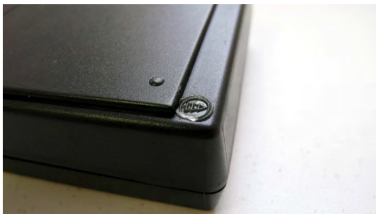
Рисунок 2 - Схема пломбировки от несанкционированного доступа
