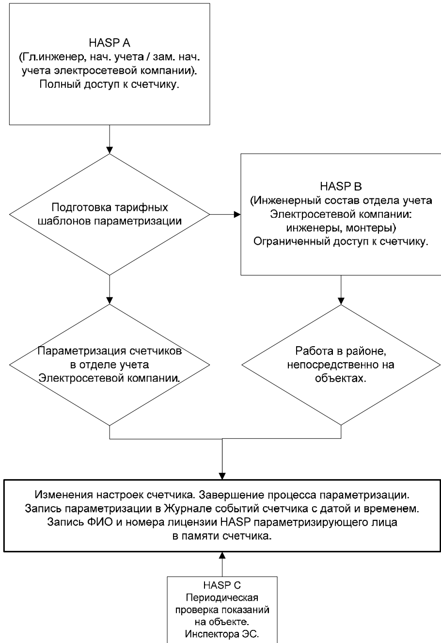
Схема 1. Структура распределения HASP-ключей в электросетевой компании
