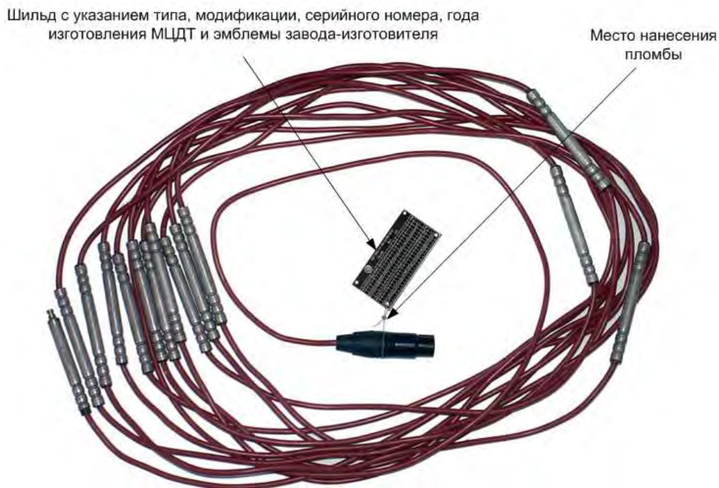
Фото 1 - Общий вид датчика температуры многозонного цифрового МЦДТ 0922
