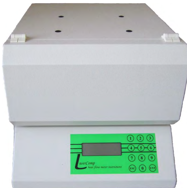
Фото 1 – Общий вид прибора для измерения теплопроводности LaserComp's FOX 200
