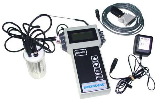
Рисунок 1 – Внешний вид анализатора содержания хлористых солей в нефти модели mod. 2100
