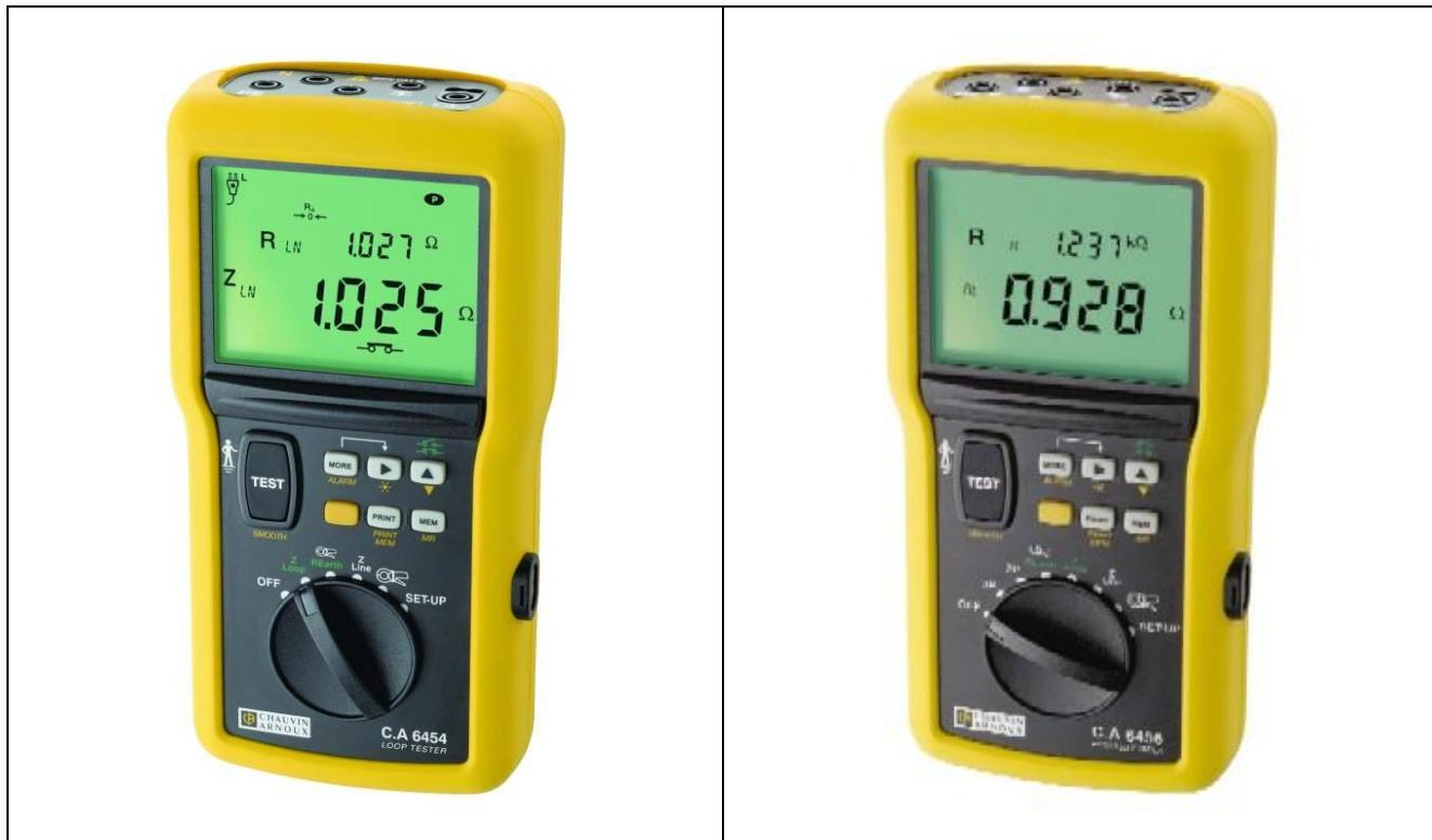
Приборы С.А 6454 и С.А 6456 выполнены в корпусе из ударопрочного пластика. Рабочее положение – вертикальное. На верхней торцевой стороне расположены контактные гнезда. На лицевой стороне расположены кнопки управления, поворотный переключатель и ЖК-дисплей с подсветкой.
