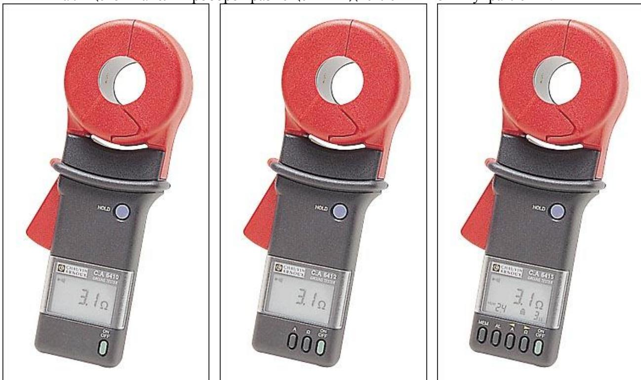
Измерители С.А 6412 и С.А 6415 помимо измерения сопротивления заземления измеряют силу переменного тока (тока утечки). Кроме этого, измерители С.А 6415 имеют дополнительные сервисные функции (звуковая сигнализация, память результатов измерений).
