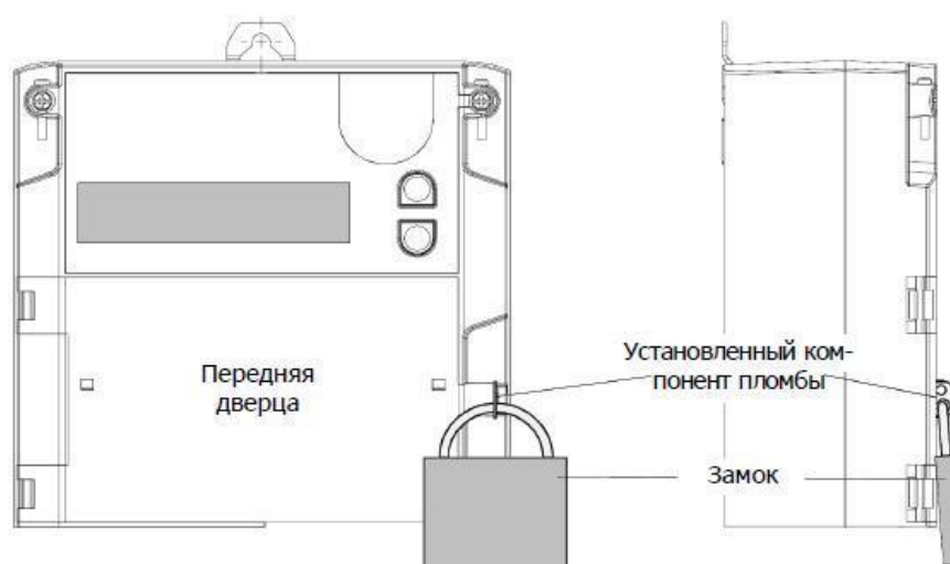
Схема пломбирования счетчика электрической энергии типа ZMD
