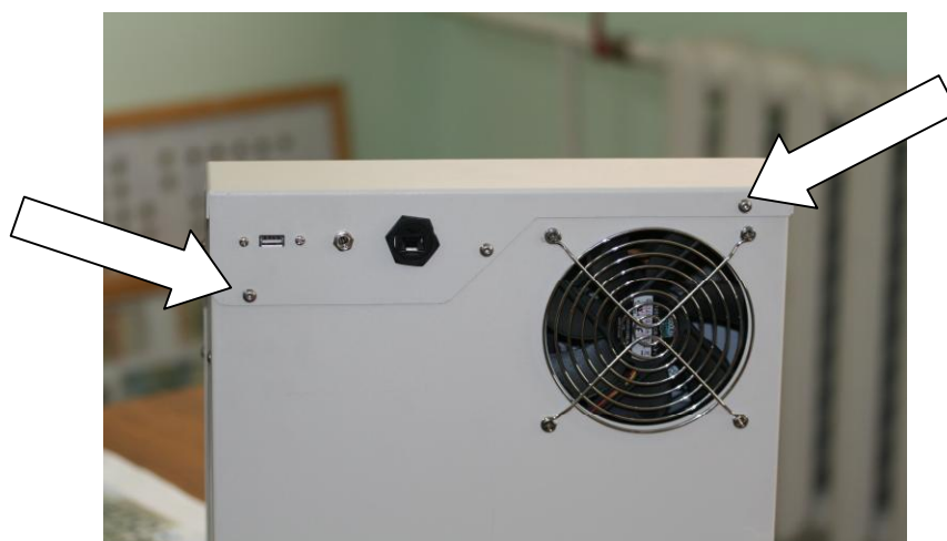
Рисунок 2 – Схема пломбировки от несанкционированного доступа
