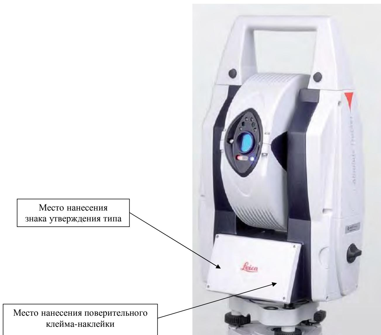
Рисунок 1 - Общий вид системы лазерной координатно-измерительной Leica Absolute Tracker AT401 и место нанесения поверительного клейма и знака утверждения типа.
