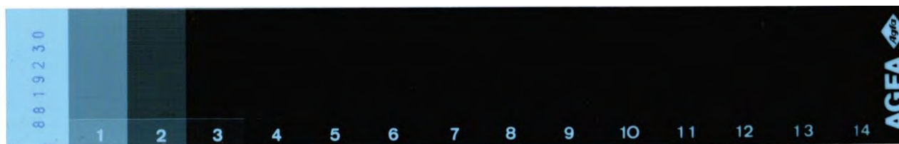
Рисунок 1 – Внешний вид набора мер визуальной диффузной оптической плотности в проходящем свете STRUCTURIX CERTIFIED DENSTEP
