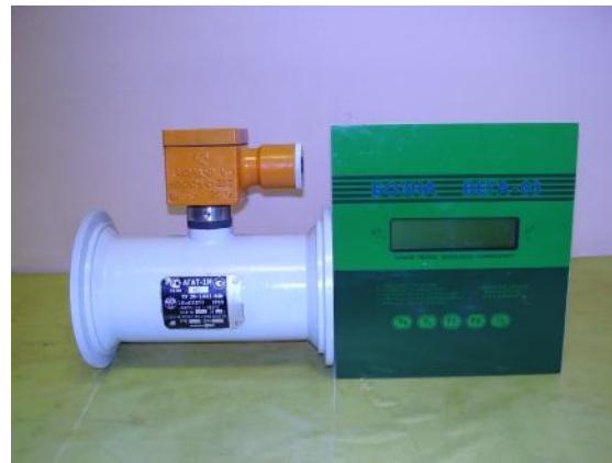
Клеймо поверителя на преобразователе расхода ставится на светлом поле таблички, расположенной на его наружной поверхности, а блока – на одном из винтов, залитом мастикой.
