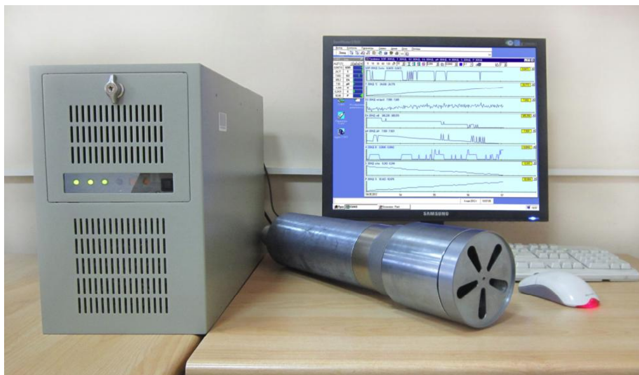
Рисунок 1. Внешний вид системы измерительной химикофизических параметров водной среды автоматической
