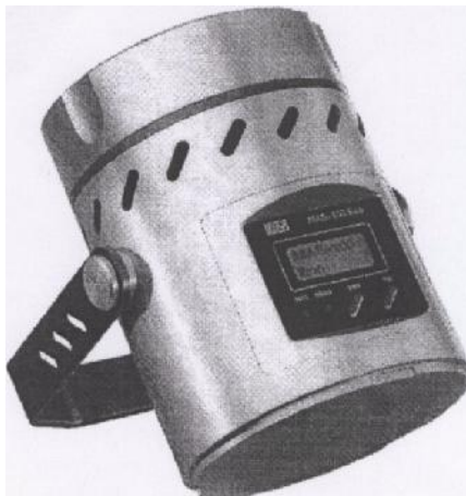
Внешний вид пробоотборника воздуха MAS-100 Eco
