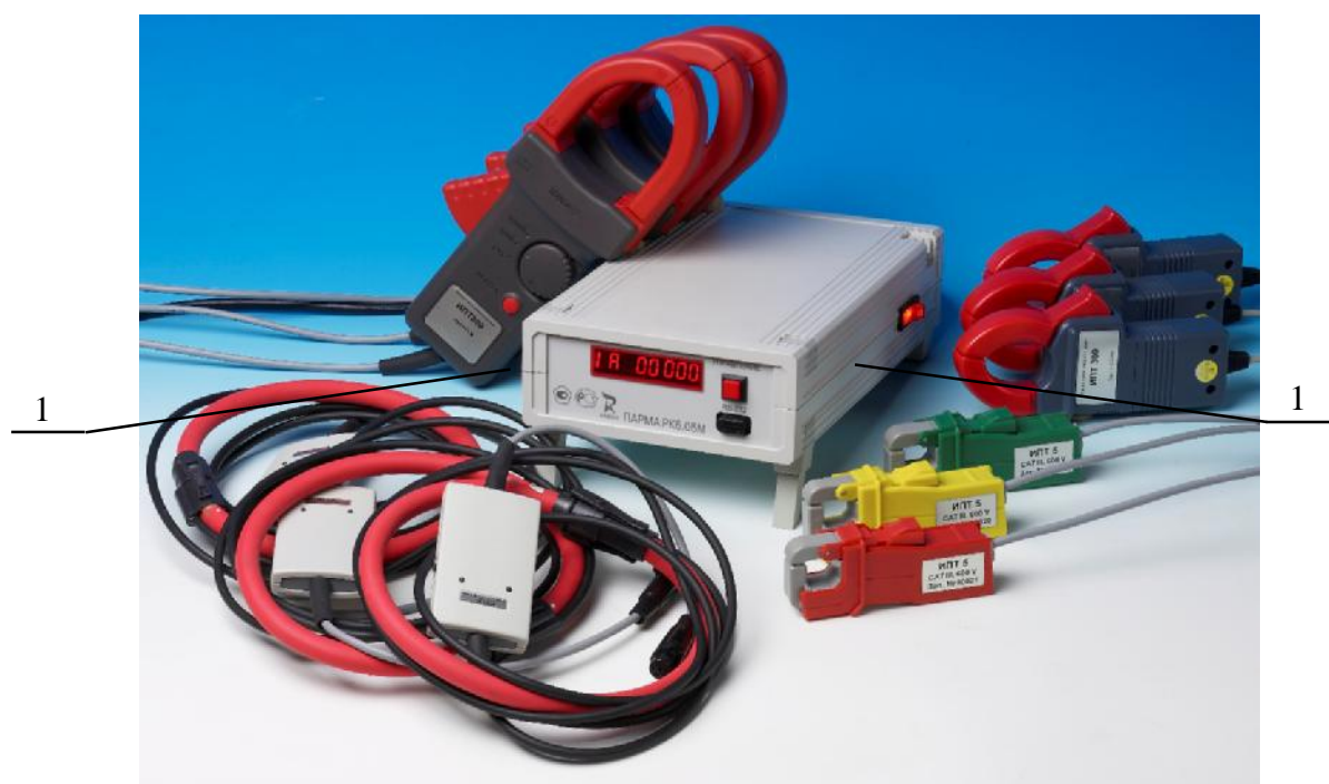
Рисунок 1 – Внешний вид и схема пломбирования от несанкционированного доступа
