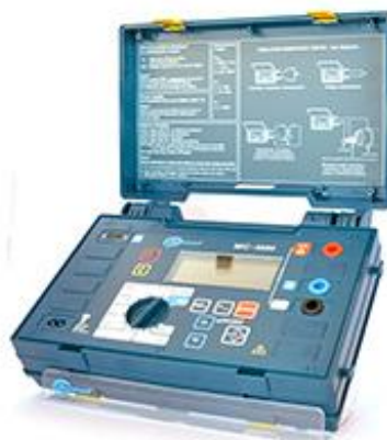
Рисунок 1 – Фотография общего вида измерителей сопротивления, увлажненности и степени старения электроизоляции MIC-5000.
