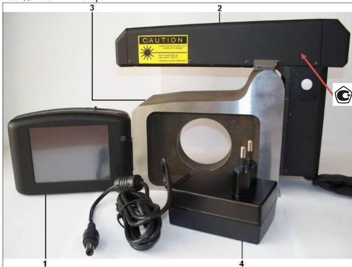
Рисунок 1 – Общий вид профилометра поверхности катания колесной пары ИКП
