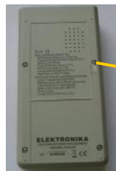
Рисунок 2- Схема пломбировки анализатора
