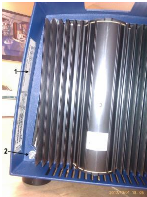
Рисунок 2 – Спектрофотометр отражения инфракрасный InfraHact с обозначением мест нанесения маркировки (1) и пломбирования (2) (вид сзади)
