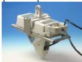
Первичный преобразователь с дополнительным погружным датчиком скорости
