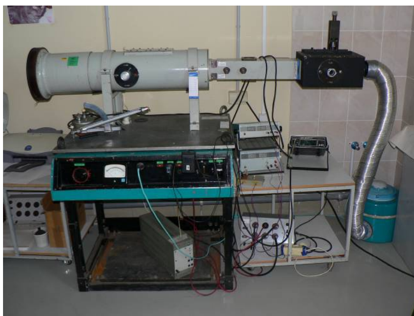
Рисунок 1 – Общий вид стенда аэродинамического САД-20-01М
