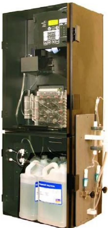
Рисунок 1. Фотография общего вида анализаторов CFA-3000, 185 со снятой передней дверью
