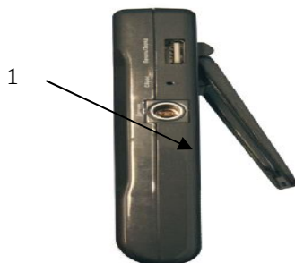
Рисунок 2. - схема пломбировки твердомера МИНИКОН 960. 1 - место пломбировки.
