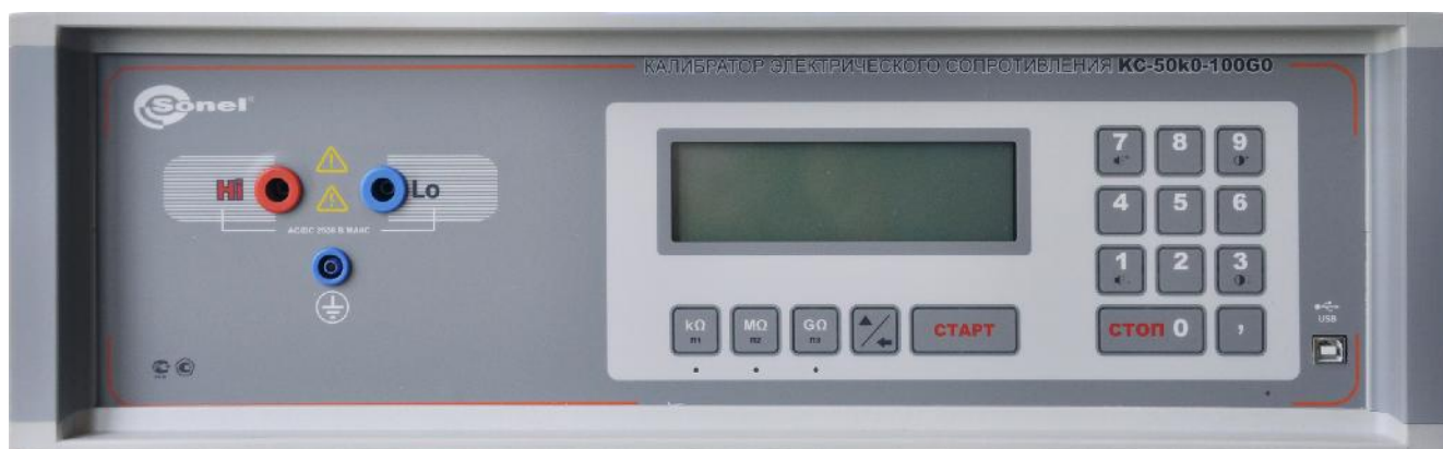
Рисунок 1 - Фотография общего вида калибраторов электрического сопротивления KC-50k0-100G0
