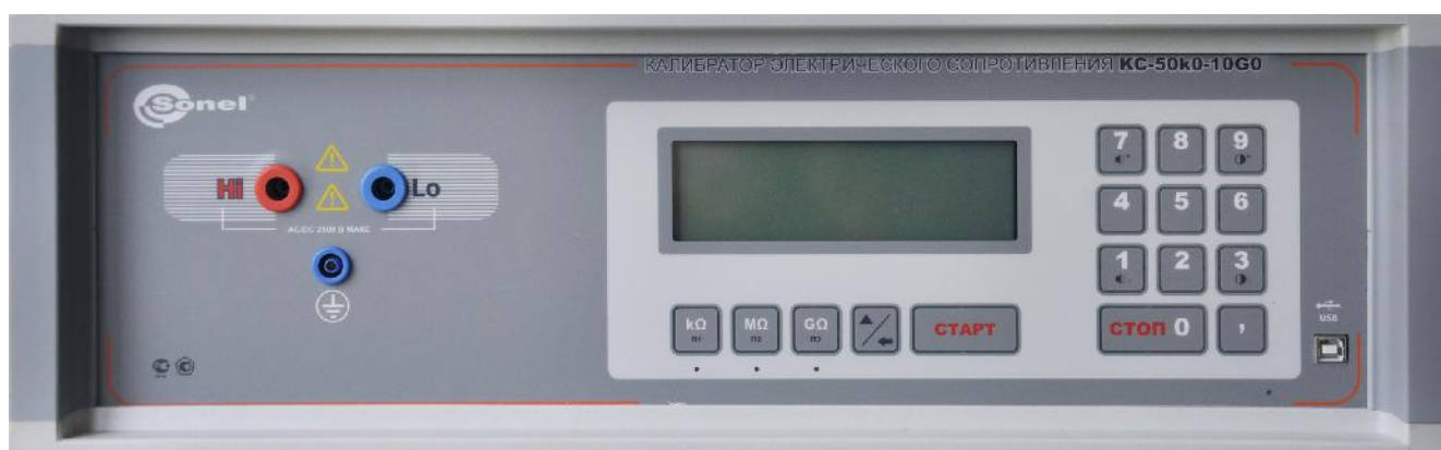
Рисунок 2 - Фотография общего вида калибраторов электрического сопротивления KC-50k0-100G0
