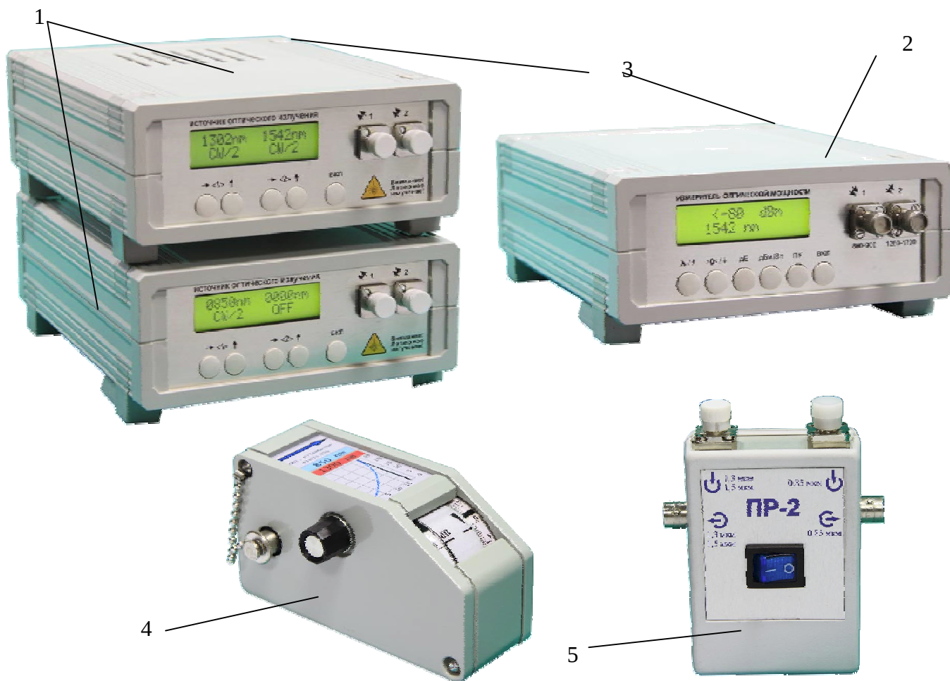
Рисунок 1 - Общий вид и места пломбирования РЭСМ-В
