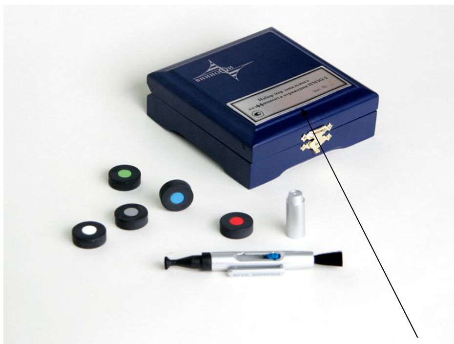
Рисунок 2 – Внешний (общий) вид набора мер зональных коэффициентов отражения HMZO-2, *- место маркировки
