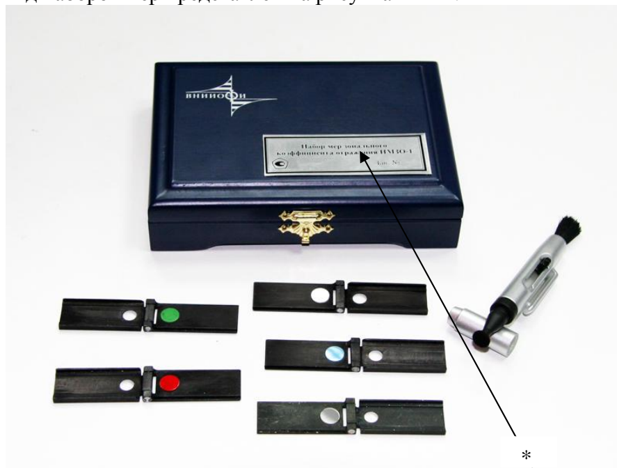
Рисунок 1 – Внешний (общий) вид набора мер зональных коэффициентов отражения НМЗО-1, *- место маркировки
