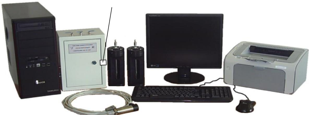
Пломбирование систем осуществляется один раз изготовителем при выпуске из производства в виде наклейки с изображением товарного знака предприятия-изготовителя на переднюю панель – дверцу и боковую стенку корпуса блока сопряжения.
