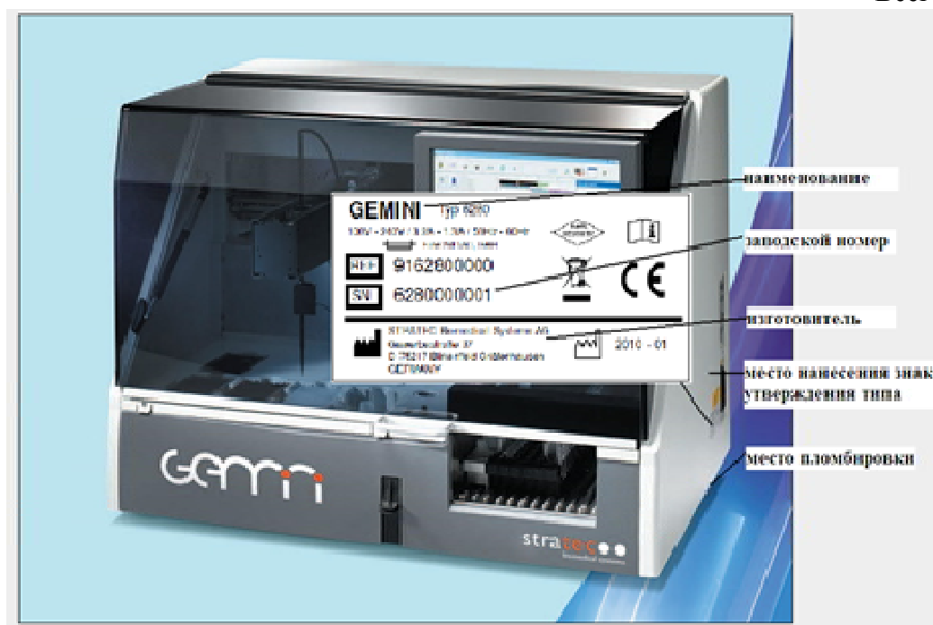
Рисунок 2 – Схема маркировки и пломбировки
