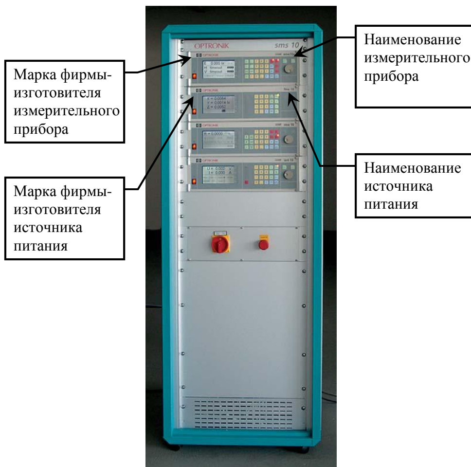
Рисунок 3 – Маркировка стойки управления с измерительными приборами sms 10h и источником питания snt 10
