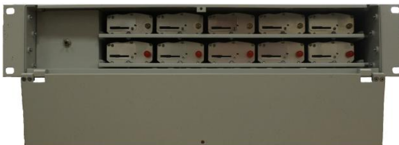
Рисунок 4.2 Модемный пул «Аксон-3М». Вид с открытой передней панелью.
