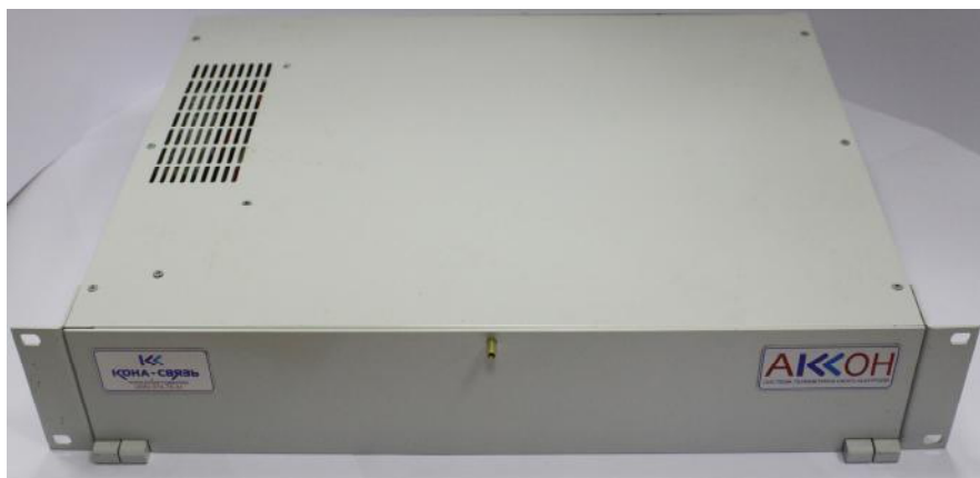
Рисунок 4.1 - Модемный пул «Аксон-3М» Общий вид
