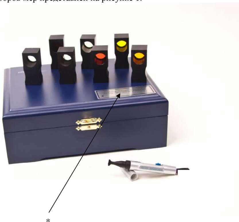
Рисунок 1 – Внешний (общий) вид наборов мер НМП моделей НМП-01 и НМП-02 , *- место маркировки
